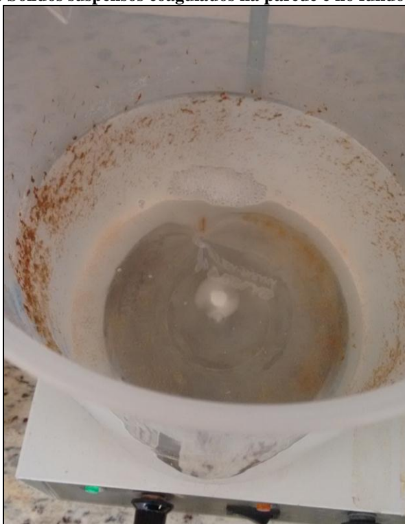
Figura 13: Sólidos suspensos coagulados na parede e no fundo do béquer.
